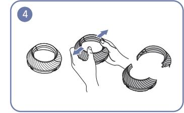
4 Disassemble the COVER-REAR TOP.
