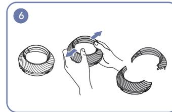
6 Disassemble the COVER-REAR TOP.
